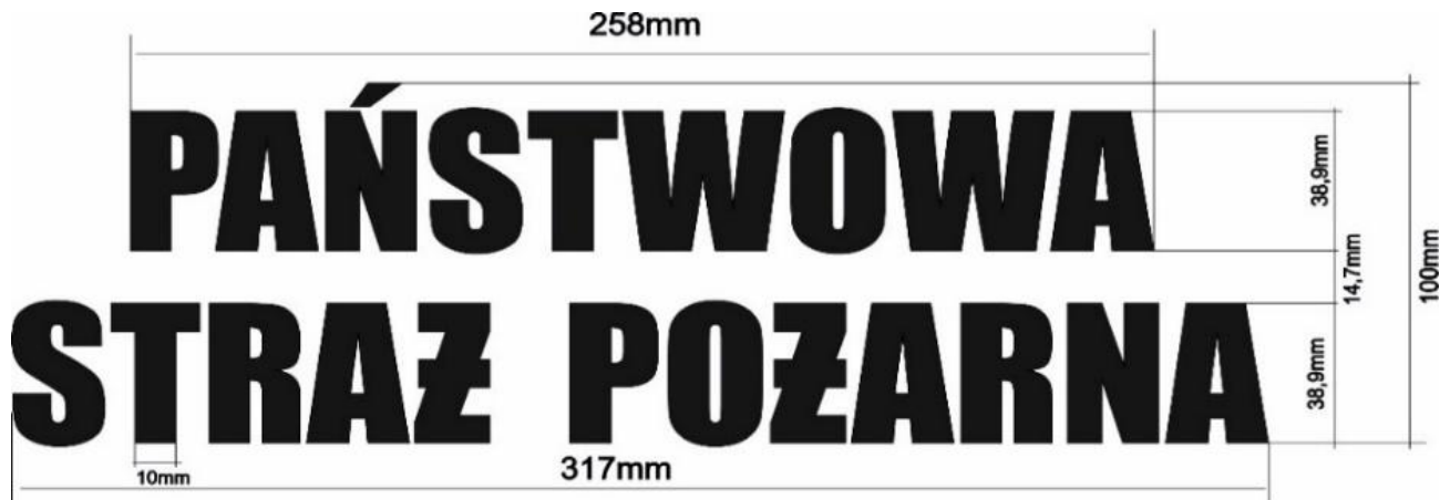
Rysunek 6 Wymiarowanie napisu Państwowa Straż Pożarna
